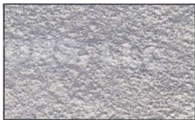
SSPC-SP 5 « White Metal » (grenaillage à blanc)
